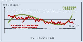
图 2 中红线表示用 Frac-N PLL 电路进行温度补偿后的温度特性。
