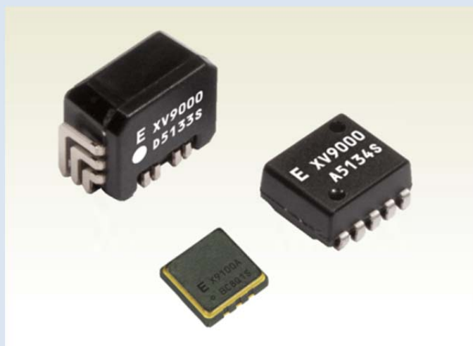
图 1：用于检测车身所处姿势状态的精工爱普生 XV-9000 系列陀螺仪传感器 (左下：CD 封装、右上：LV 封装、左上：LP 封装)
