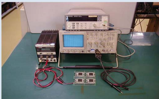
図1 周波数マッチングの評価に必要な測定器の基本構成 図2 FETプローブを水晶振動子のHOT端子に当てて発振波形を確認している様子
